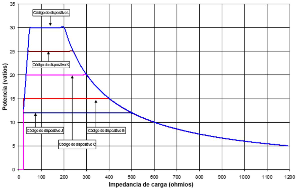
Figura 12: comparación de potencia y carga (algoritmo de la lápiz)
