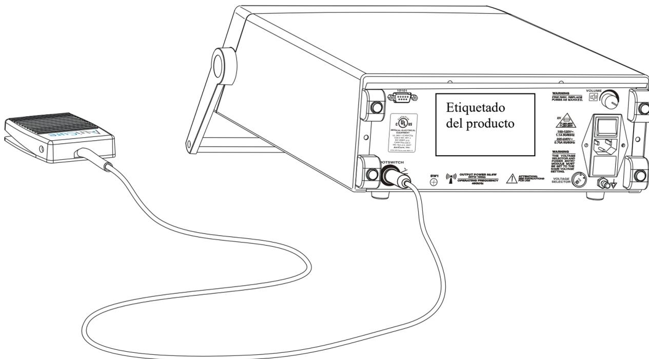
*Figura 4: conexión del pedal a la ASU*
