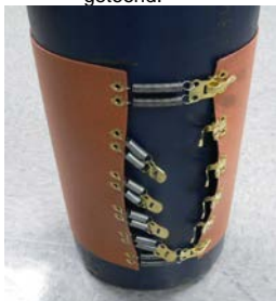
Afbeelding 2 – Borgveren vastmaken, bovenste en onderste veren eerst.
