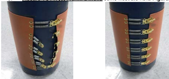
Figura 2 – Fissare i fermi a molla, per primi quello superiore e quello inferiore.
