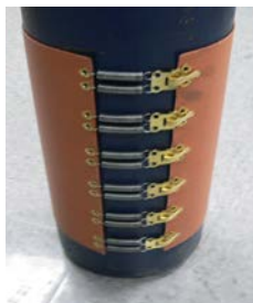
Afbeelding 2 – Borgveren vastmaken, bovenste en onderste veren eerst.
