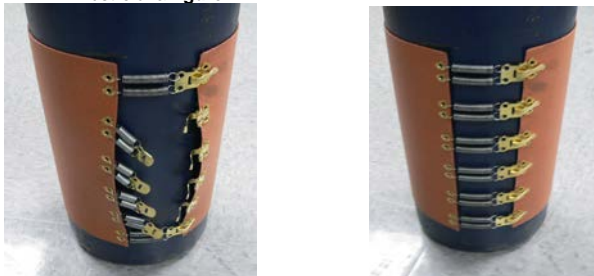
Figure 2 – Dispositifs de retenue à ressort fermés, dispositifs haut et bas en premier.
